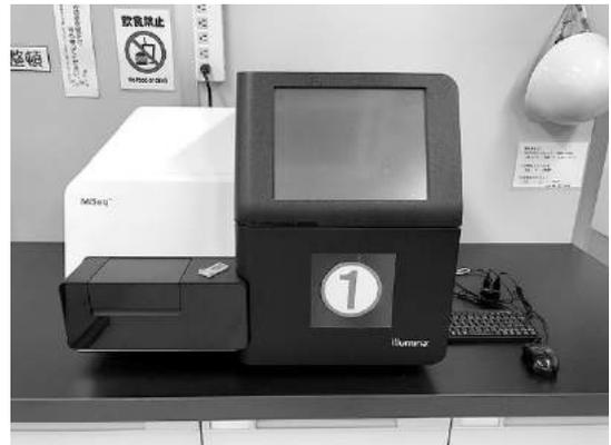
概要                   本装置は、ペアエンドリードの自動化が可能で、1 ランあたり最大15Gbに達し、1 回のリードで600を超える塩基のデータが得られます。バイオアナライザー、フルオロメーター、遠心分離機、冷凍庫、冷蔵庫といった周辺機器も導入し、1 スポットでシーケンスが可能となりました。
